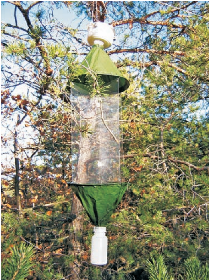
Abb. 4: Baumfalle (4-Seiten-Luftteklektor). Dieser Fallentyp erfasst fliegende Zikaden
