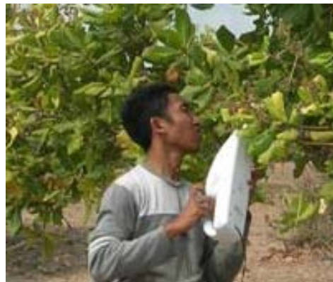
Gambar 5.1 Pengambilan contoh WPM dengan penghisap debu SANEX ED-912
