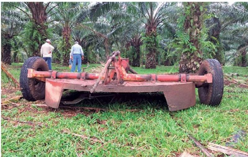
**Figura 10.** Rastra para cortar gramíneas y remover raíces con el fin de preparar el suelo para la siembra de leguminosas.
