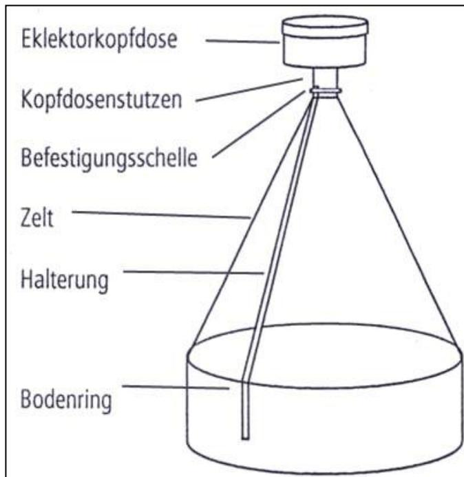
**Abb. 1: Schematische Skizze des verwendeten Bodenphotoelektors**
