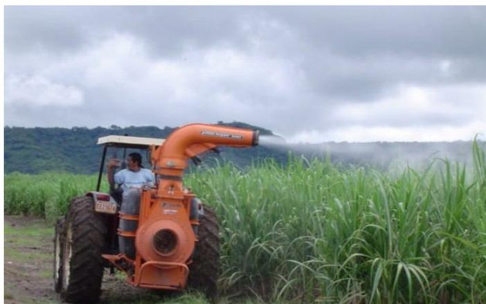
Figura 4. Cañón o Boom para aplicación de *M. anisopliae*.
